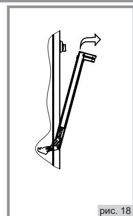
**ПРЕДУПРЕЖДЕНИЕ!** При проведении работ со снятой дверцей ни в коем случае нельзя снимать упоры дверцы, т.к. это вызовет резкий рывок цапф шарниров, что может нанести травму.
