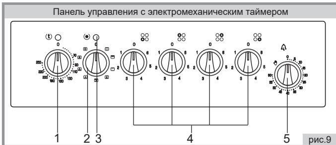
**Примечание:** Вместо поз. 5 может быть установлен электронный таймер или рукоятка механического таймера.
