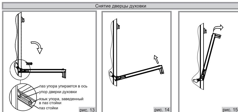
**! ПРЕДУПРЕЖДЕНИЕ!** При проведении работ со снятой дверцей ни в коем случае нельзя снимать упоры дверцы, т.к. это вызовет резкий рывок цапф шарниров, что может нанести травму. Когда моете жарочный шкаф, будьте аккуратны — не повредите резиновое уплотнение.
