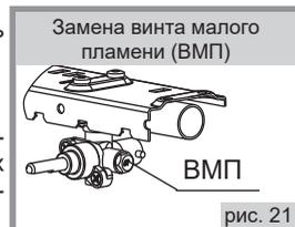
■ Винт малого пламени (ВМП) устанавливается с моментом  $M_{кр}=4 \text{ Н}\cdot\text{м}$  ( $0,4 \text{ кг}\cdot\text{м}$ ). Перед установкой винта его необходимо смазать маслом И-20А ГОСТ 20799-88. Тип винта определяется видом газа (природный или сжиженный) по табл. 1.
