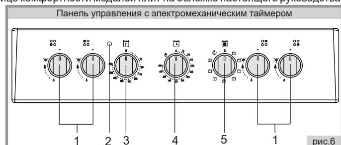
**Примечание:** Вместо поз. 4 может быть установлен электронный таймер или рукоятка механического таймера.
